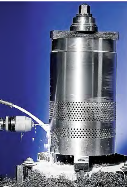
Herstellung eines Lochdrosselkörpers Manufacturing of a throttle insert
