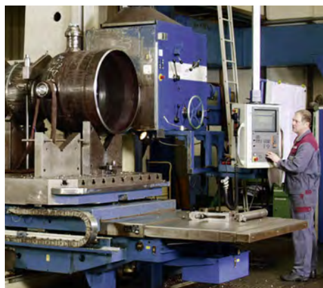
Endbearbeitung eines Ventilkörpers Final manufacturing of a valve body
