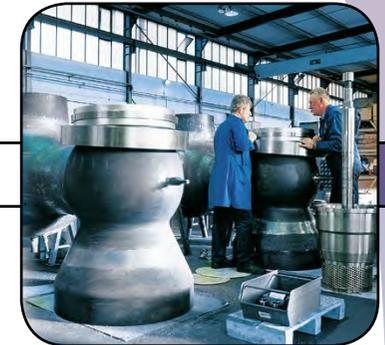
Dampfumformventile vom Typ E20/E40 sind durch die Art der Einspritzung für den Einsatz als Mitteldruck- und Niederdruck- Bypass Stationen vorgesehen. So befindet sich der Austritt dieser Ventile häufig in der Nähe oder unmittelbar vor dem Kondensator. Auf einer möglichst kurzen Rohrleitungsstrecke zwischen Ventilaustritt und Kondensator soll Umleit- und Überproduktionsdampf auf die notwendigen Kondensatorparameter gebracht
