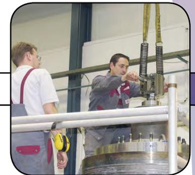
zungsabteilung prüft die Teile und Armaturen auf ihre weitere Verwendbarkeit und setzt sie fachmännisch instand, wobei neu hinzugewonnene Kenntnisse in die Konstruktion und Materialtechnik integriert werden.
